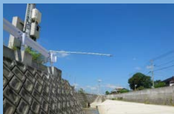
センサーにより常時、10分毎に自動計測
